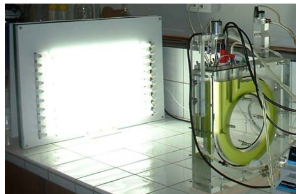
Photobioréacteur d'étude pour la bioproduction d'hydrogène
